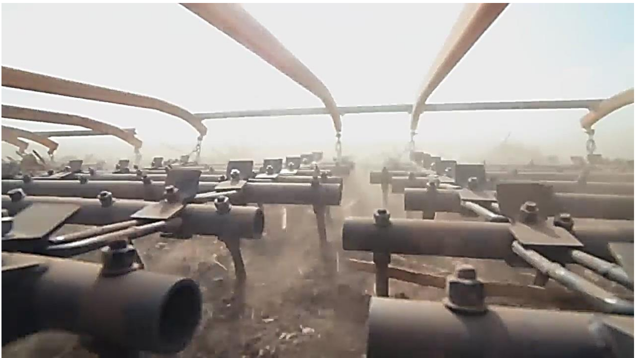
Шарнірная сувязь паміж шэрагамі зуб'яў з пасіўнымі кутамі іх усталёўкі да паверхні глебы 120 аб ці 1350 выняткуўвае забіванне працоўнага палатна пожнівнымі і расліннымі рэшткамі
