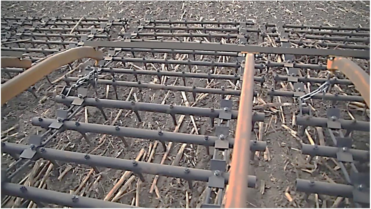
Шчыльнасць пакрыцця паверхні глебы слядамі зуб'яў бароны з 16-ти рядным размяшчэннем складае 64 зуб./м 2
