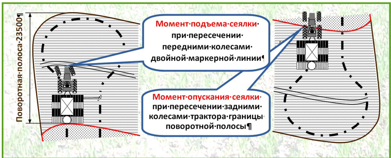
Траекторыя руху пасяўнога агрэгата на паваротнай паласе з вызначэннем моманту ўздыму і апусканні агрэгата
