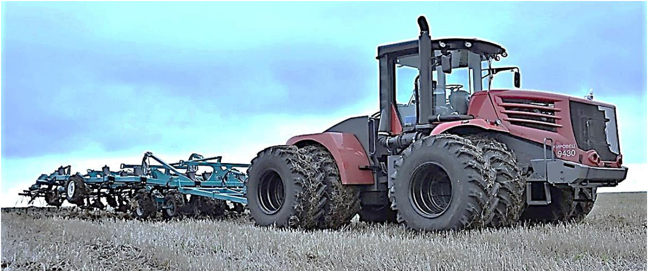
Ранньовесня апрацоўка зябліва трактарам К-9360 у агрэгате з культыватарамі "Карат - 9КА" або "Вектар - 900" з шырынёй захопу 9 м.
