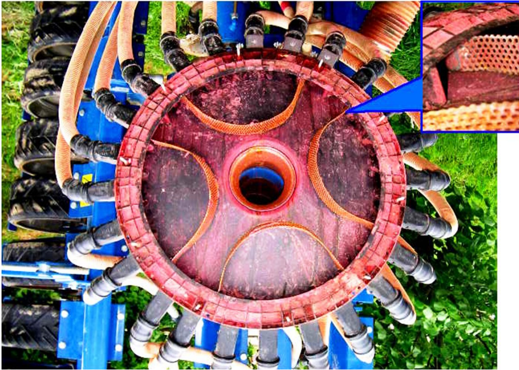
Мал. 8. Варыянт перакрыцця трубаправодаў усталёўкай металічнай сеткі
