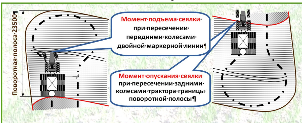
Траектория руху пасяўнога агрэгата на паваротнай паласе з вызначэннем моманту ўздыму і апусканні агрэгата
