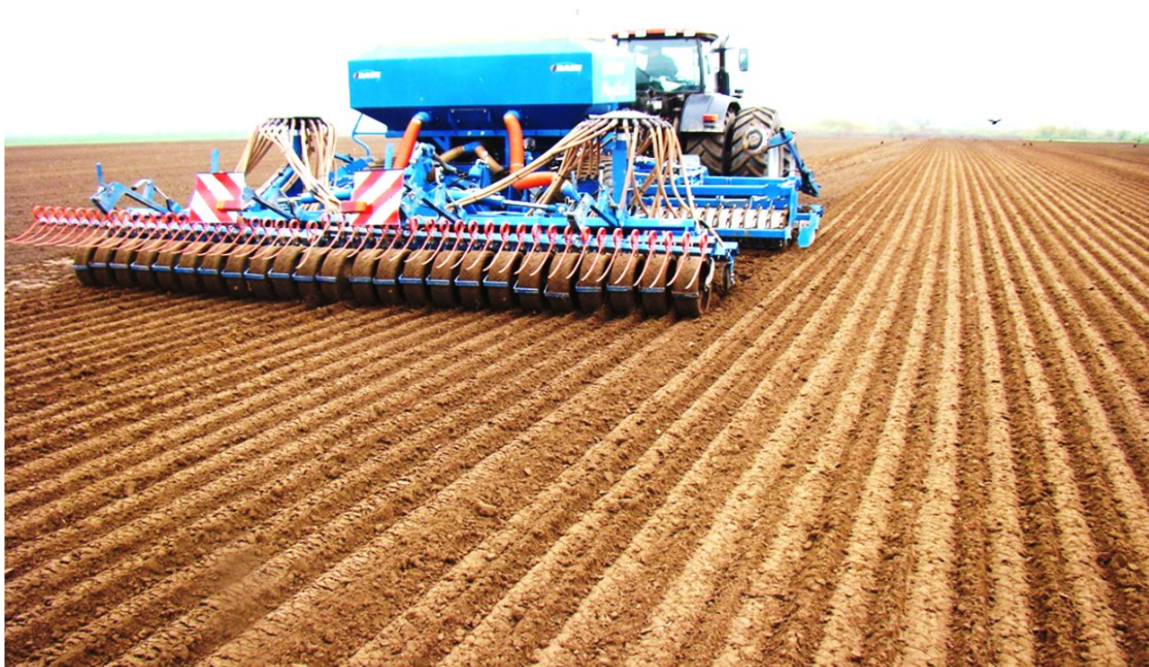
Мал. 14. Пасеў кукурузы па двухрадковай схеме агрэгатам Mega Seed T-6002 K2
