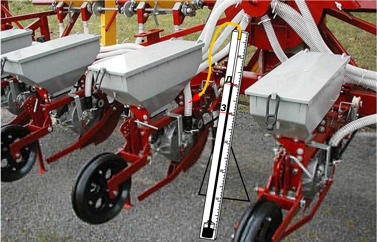
Мал. 7. Кантроль здольнасці ўтрымліваць вакуум высейваючымі апаратамі з дапамогай вадкага вакуумметра
