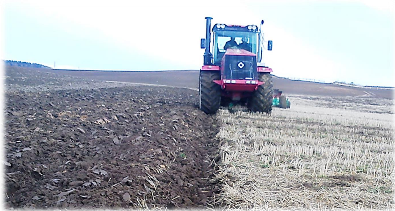
Мал. 12. Злітная і роўнаглыбінная ворыва плугам ПВА-9-45+1-30 пры ваджэнні трактара К-9360 правым (або левым) бортам у паўбарозе.
