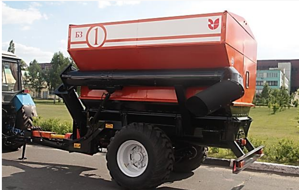
Мал. 9. Бункер-загрузчик насення і ўгнаення БЗ-1 Гомельскі завод ліцця і нармалей ААТ "Гомсельмаш"
