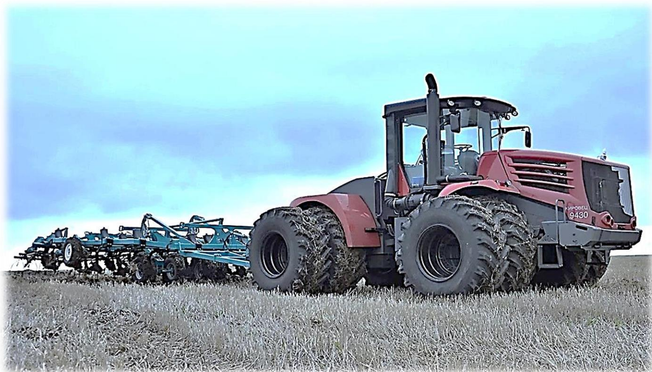
Мал. 11. Апрацоўка іржышчавых аграфонаў трактарам К-9360 у агрэгате з культыватарамі "Карат - 9КА" або "Вектар - 900" з шырынёй захопу 9 м.
